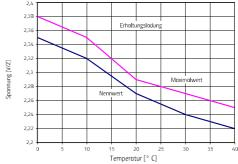
${\it Marathon, Sprinter-Ladespannung\ versus\ Temperatur}$
