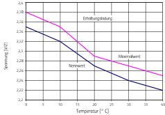
${\it Marathon, Sprinter-Ladespannung\ versus\ Temperatur}$
