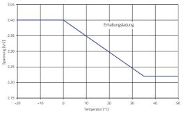
Marathon M, Sprinter-Ladespannung versus Temperatur
