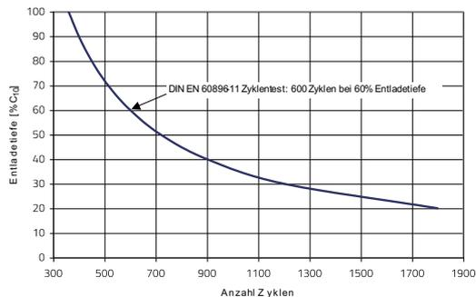
Abb. 10: OGi, Energy Bloc – Anzahl Zyklen versus Entladetiefe
